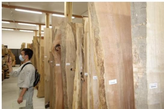
ったが、新型コロナウイルス感染症の影響で県域を越えた出張等自粛のため、制限解除を待って実施したもの。朝7時30分山形発夕方6時着の強行軍でしたが、得られた成果も多く、写真にもあるように製材品をある程度横積みで乾燥した後、縦並びで乾燥しながら見せる工夫をしている。その在庫量は各倉庫棟に半端ない量が納められ、その一つ一つに樹種と価格がバーコードとともに貼付されていた。人工乾燥装置も所有しているが、基本は天然乾燥であると社長は強調した。店を訪れる客層は7割が首都圏の方でリピーターが多いとのこと。
